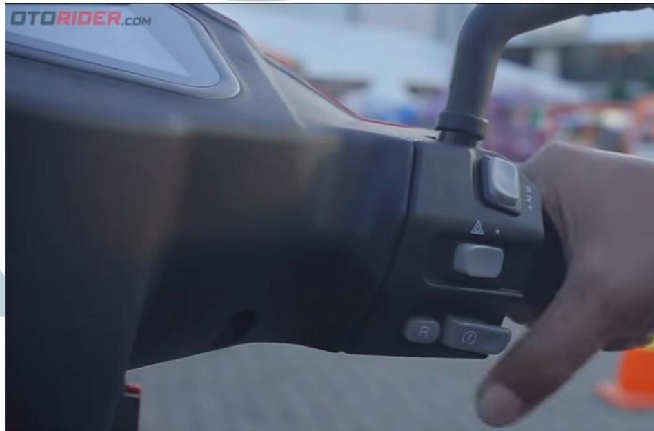
Gambar 3.8: *Reverse gear* pada motor Gesits
