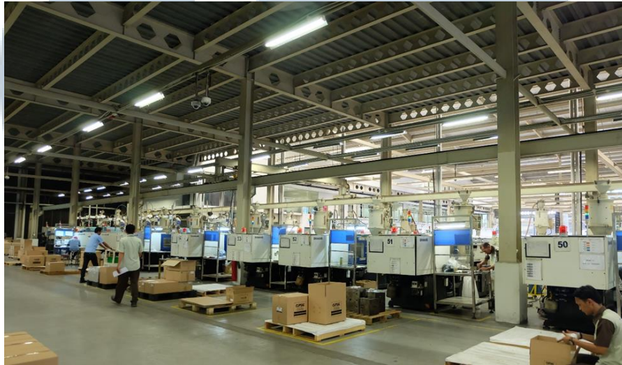
Gambar 3. 6 Proses Injeksi pada PT. Lelco Trindo Nusantara
