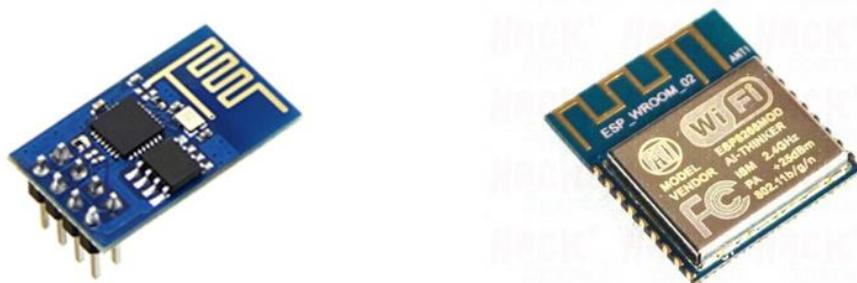
Gambar 2.15 Modul Wi-Fi ESP8266-01 dan ESP9266-13
