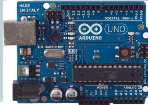
Gambar 2.4 Mikrokontroler Arduino Uno
