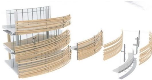
**Gambar 2. 6 Explode Struktur Fasad**
