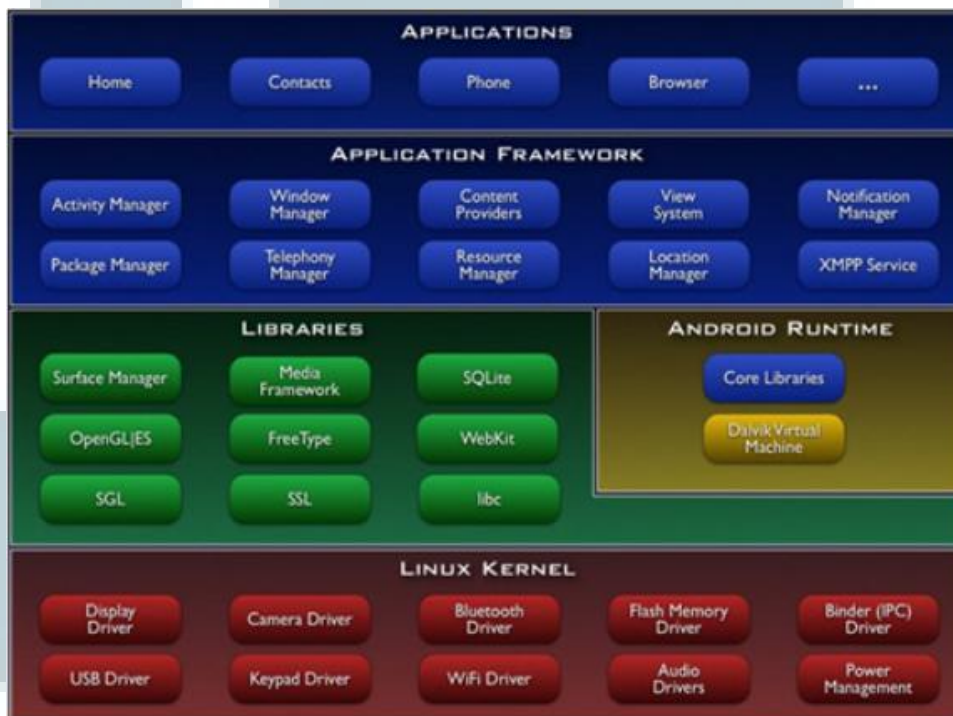
Gambar 2.1. Lapisan sistem operasi Android
