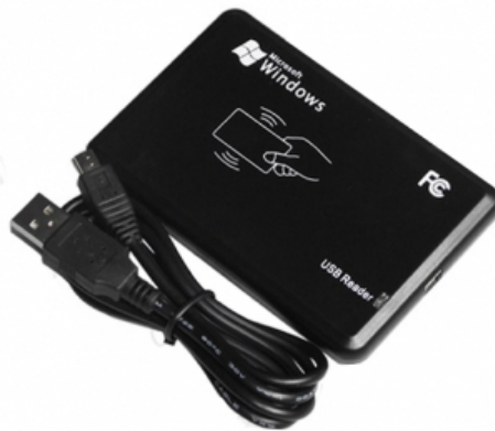
Gambar 3.9. Tampilan RFID Reader
