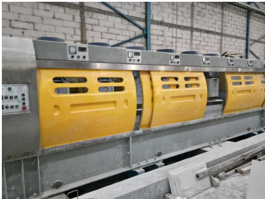
Gambar 3. 24 Mesin Grind Pertama
