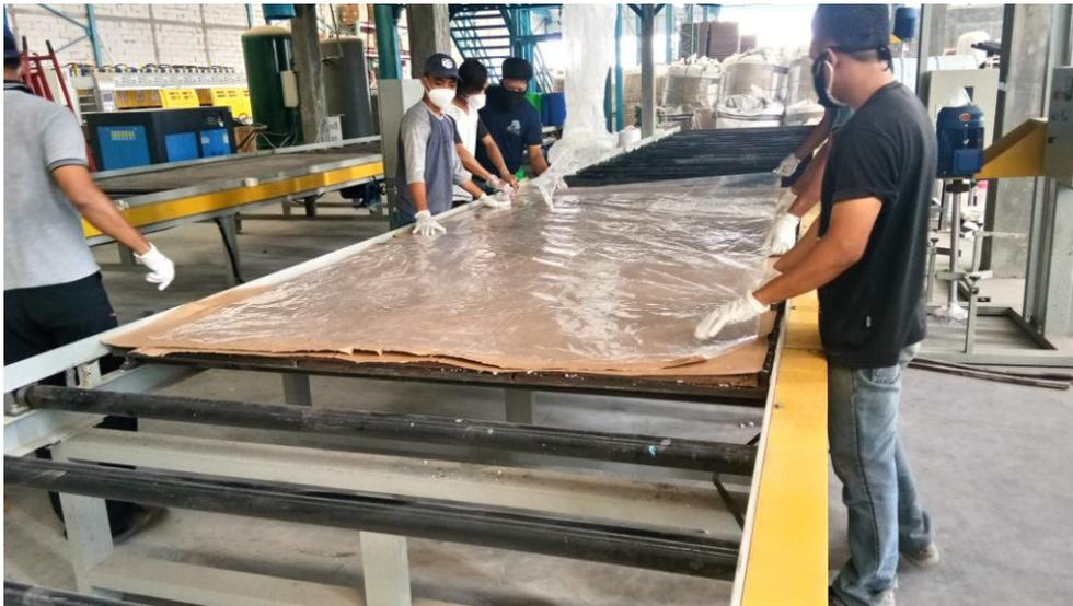
Gambar 3. 13 Penutupan Adonan dengan Lembar Plastik
