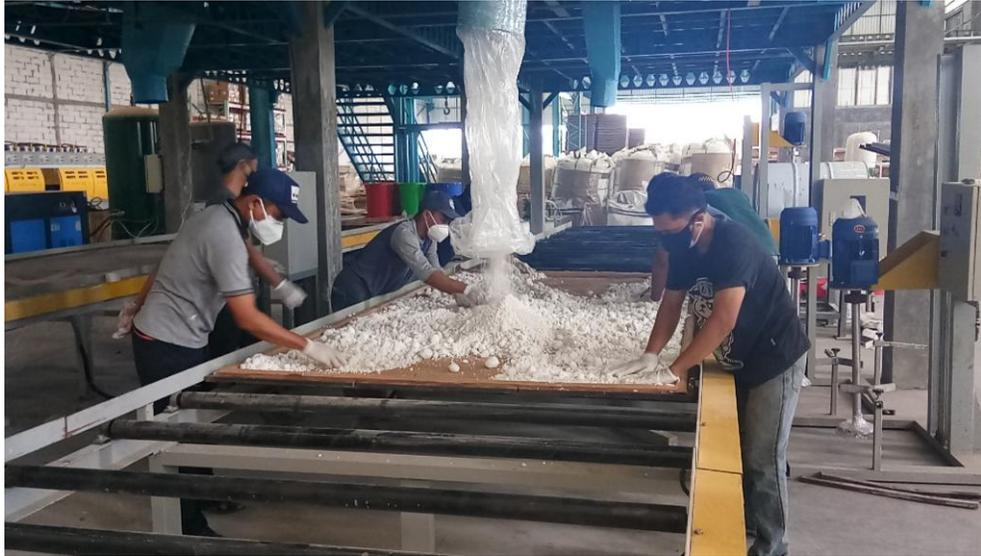
Gambar 3. 10 Proses Penurunan Adonan dari Mesin *Mixer* Lantai Atas
