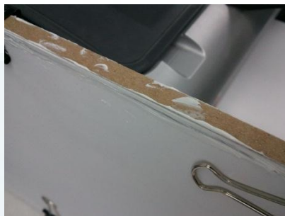
Gambar 2.4. Perfect Binding Step 3 : Punggung kertas ditutup www.instructables.com , n.d.
