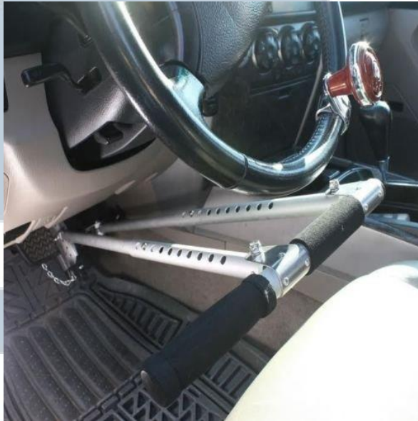
Gambar 1.2 Liberty Staff, salah satu alat bantu mengendara mobil untuk orang dengan disabilitas pada kaki.
