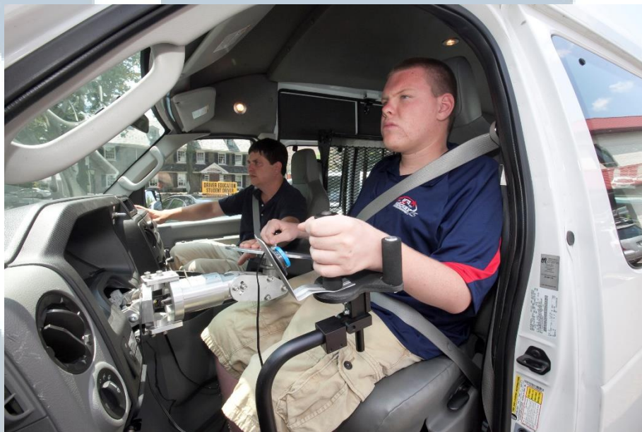
Gambar 1.1 Mobil yang dimodifikasi untuk membantu penyandang disabilitas kaki mengendara mobil. [2]
