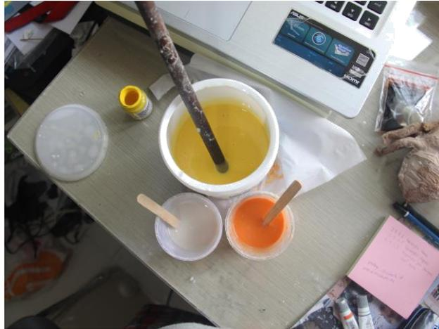
Gambar 3.31. Proses Pemberian Warna pada Silikon
