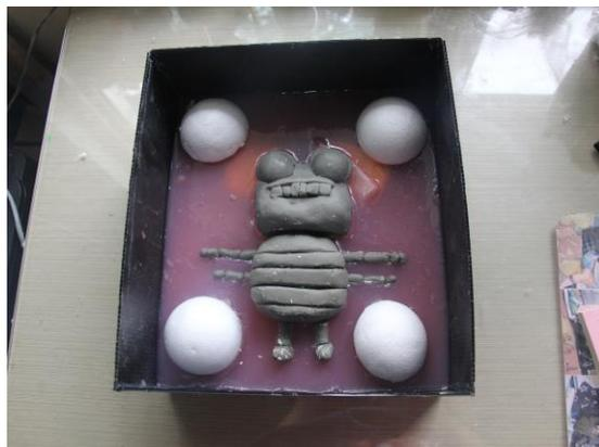
Gambar 3.26. Penggunaan Agar dan Bola *Styrofoam* untuk membuat cetakan sementara
