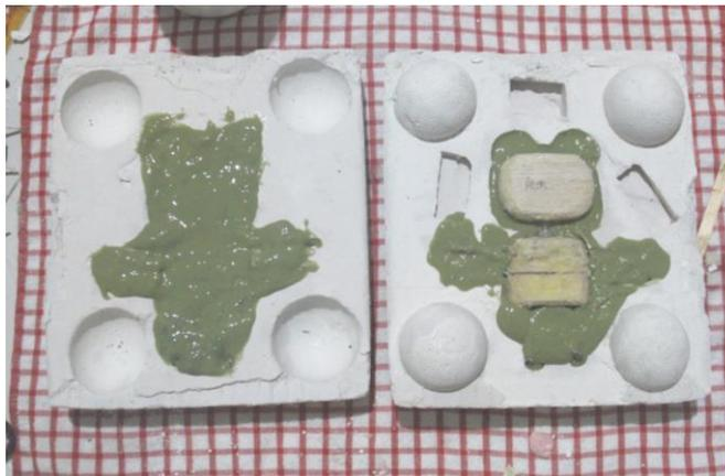
Gambar 3.32. Proses Pencetakan Silikon dengan *Armature*
