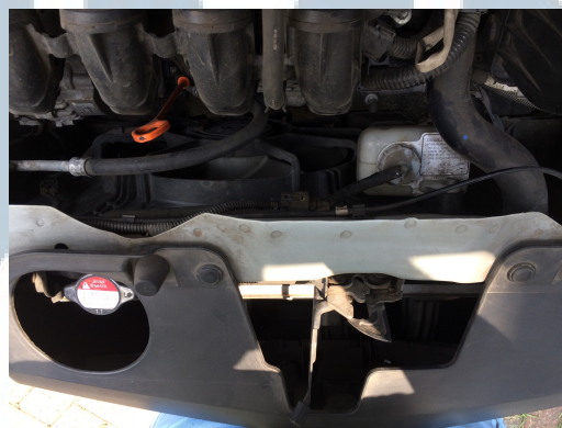
Gambar 3.12. Reservoir Tank (Dokumentasi Pribadi, 2017)
