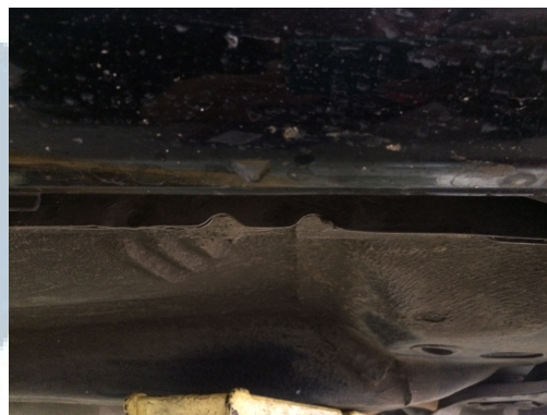
Gambar 3.9. Penempatan Dongkrak Pada Mobil Kecil (Dokumentasi Pribadi, 2017)
