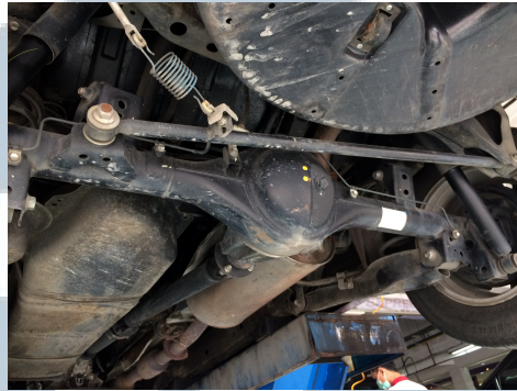
Gambar 3.7. Penempatan Dongkrak Pada Mobil Besar Bagian Belakang (Dokumentasi Pribadi, 2017)
