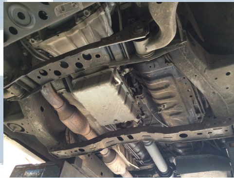
Gambar 3.8. Penempatan Dongkrak Pada Mobil Besar Bagian Depan (Dokumentasi Pribadi, 2017)
