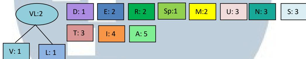
Gambar 5.2 Iterasi ke-2 pembentukan Pohon Huffman
