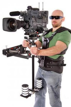
Gambar 2. 36. Memegang Kamera Dengan Bantuan Alat Penyeimbang
