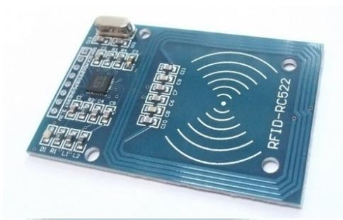
Gambar 2. 1MFRC522 RFID Reader [15]
