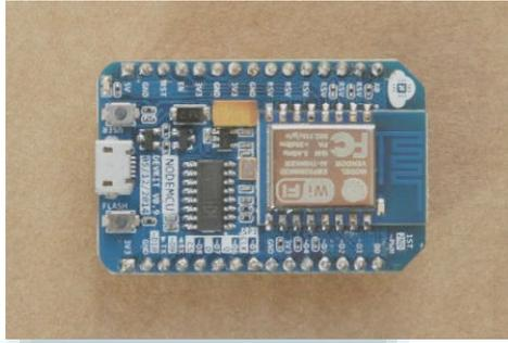
**Gambar 2. 12 NodeMCU Development Kit dengan ESP8266 [22]**
