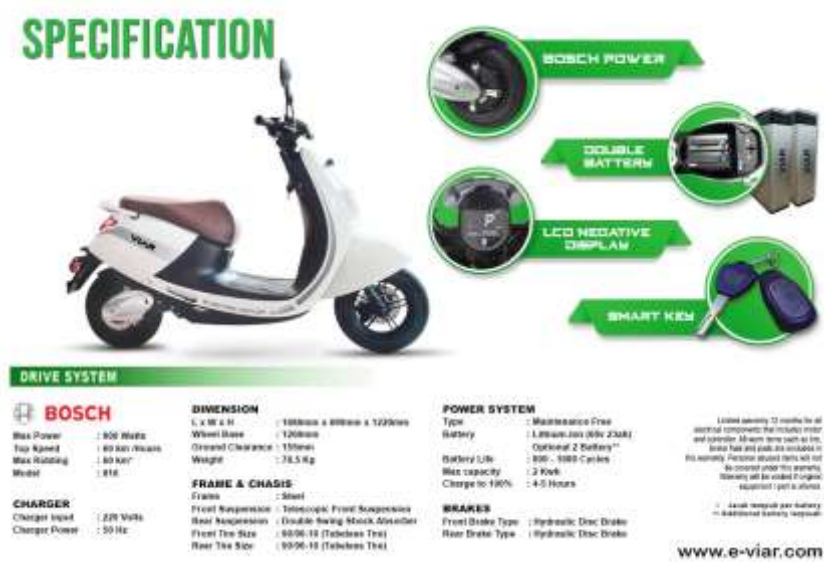
Gambar 3.9. Spesifikasi motor listrik Viar
