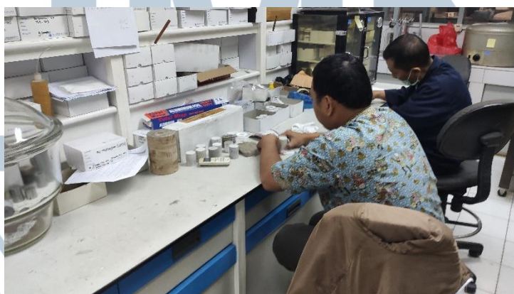
Gambar 3.7. Proses pengamplasan sampel oleh tangan
