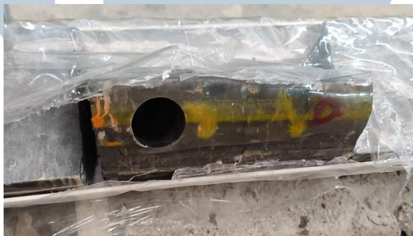
Gambar 3.2. Core yang sudah melalui proses plugging
