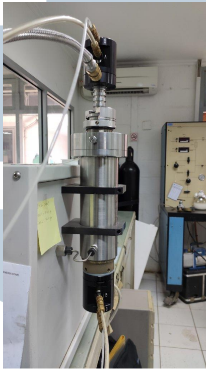
Gambar 3.8. Tabung silinder tempat sampel diukur
