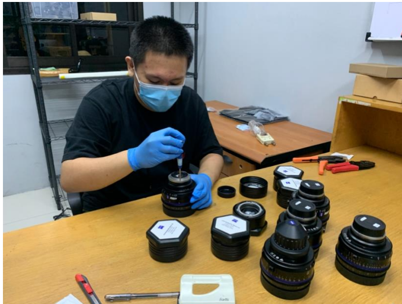
Gambar 3.4. Penulis Mengganti Mounting Lensa CP.2 PL to EF (Sumber: Dokumentasi Pribadi)
