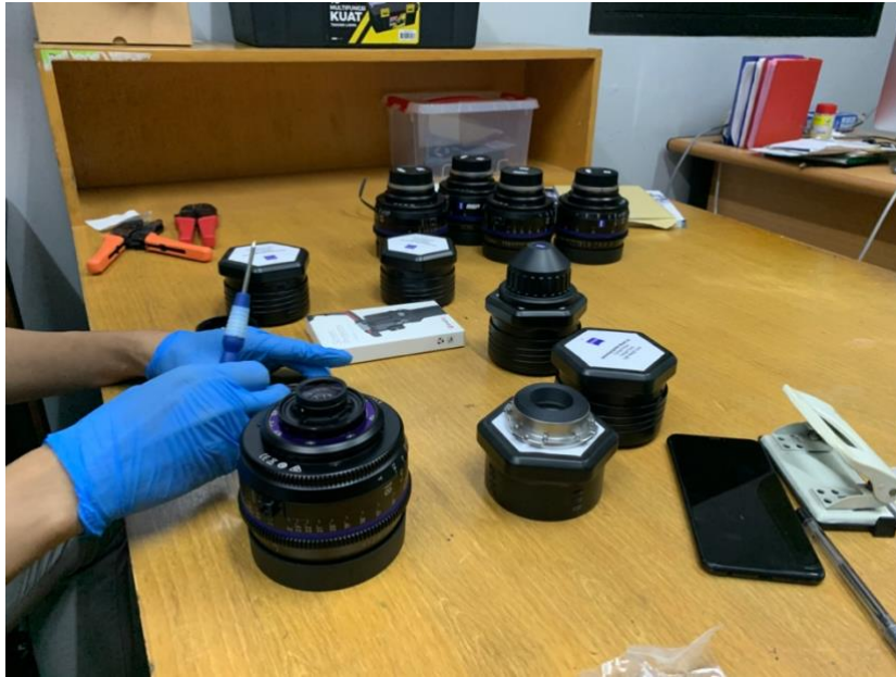
Gambar 3.3. Proses Penggantian Mounting (Sumber: Dokumentasi Pribadi)
