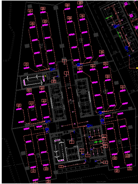
Gambar 3.1 Instalasi Titik Penerangan dan Wiring Proyek HBB Batam Office
