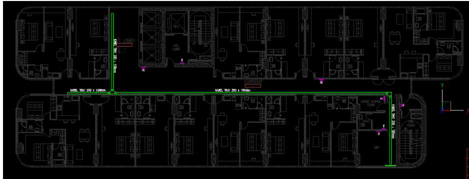
Gambar 3.7 Instalasi Stop Kontak dan Kabel Tray Proyek Hotel Setiabudi Bandung – Lt. Genap Tipikal
