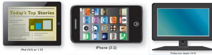
Gambar 2.13. Aspek Rasio pada Layar Perangkat Elektronik
