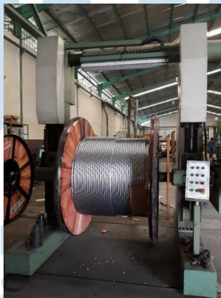
Gambar 3.6 Bobbin Besar yang Dipakai di Mesin Stranding KS-1
