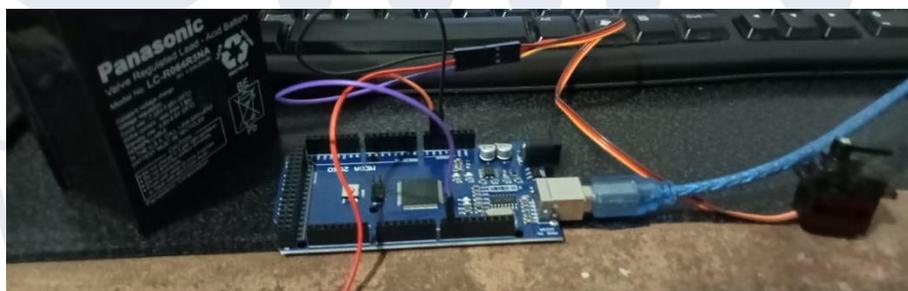
Gambar 3. 27 Percobaan pada modul *Servo Motor* MG996R.
