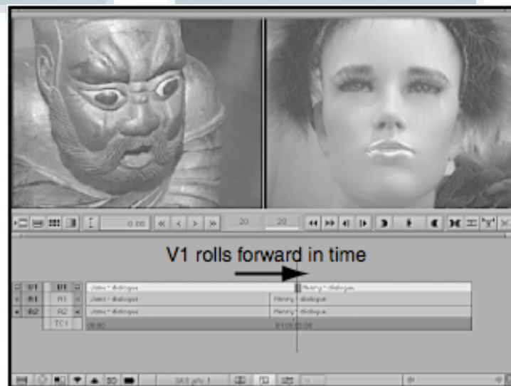
Gambar 2.4 Dialog overlap diatas menggunakan proses rolling edit , terlihat disini dengan Avid Media Composer, timeline dan layar trim mode . Video track rolls edit sebelah kiri sebagai A-side dari edit yang diperpanjang dan B-side yang diperpendek secara simultan.
