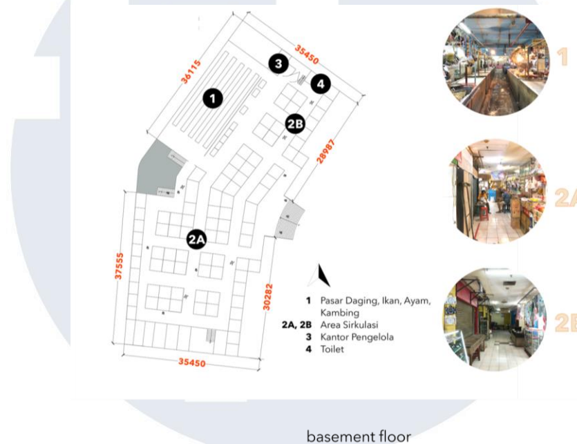
Gambar 1.9. Kondisi Lantai Basement
