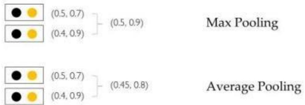
Gambar 2.3 Max Pooling dan Average Pooling
