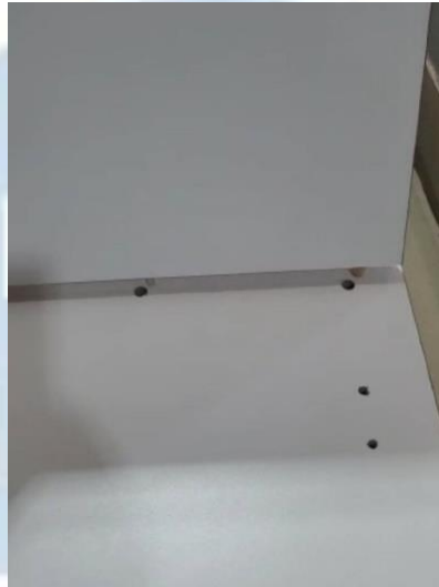
Gambar 1.8 Foto Edging Pada Sisi Yang Salah
