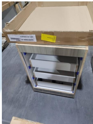
Gambar 1.9 Foto Kabinet Tidak Memiliki Backpanel
