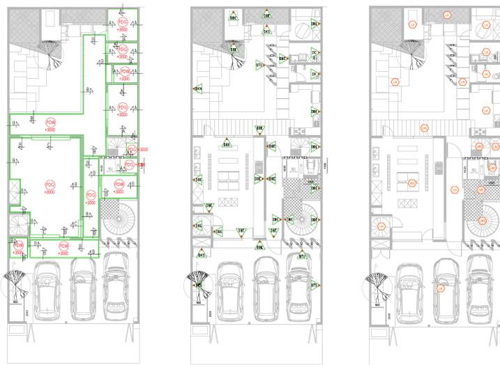
**Gambar 3.23 Gambar *Reflective Ceiling Plan*, rencana *finishing* dinding, dan rencana *finishing* lantai**
