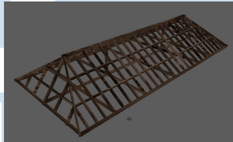
Gambar 3.11. Kerangka atap Rumah Yana
