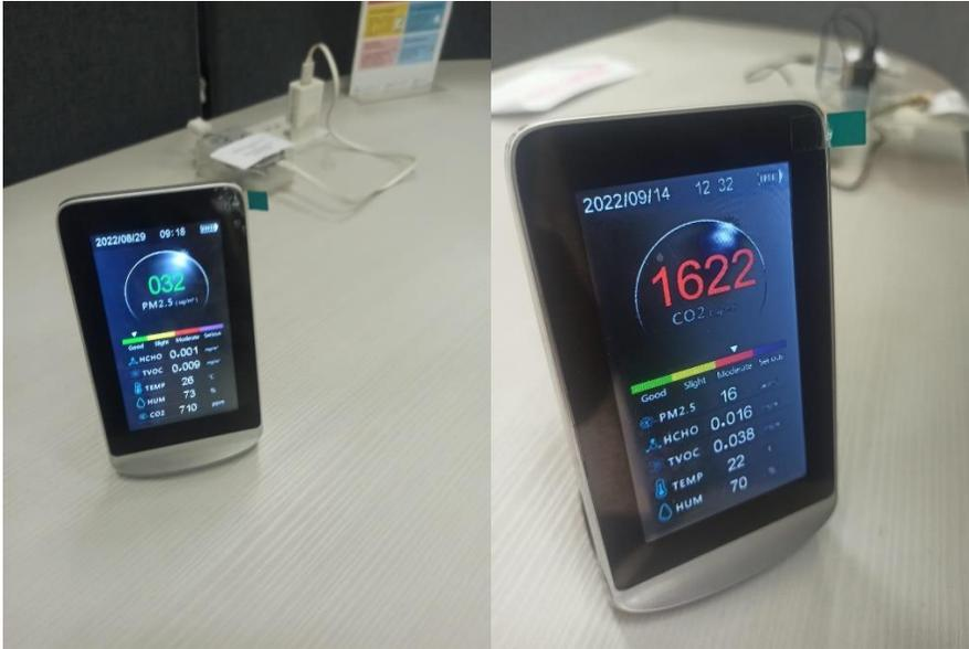
.Gambar 3.3 Penempatan Alat Ukur Air Quality Monitor
