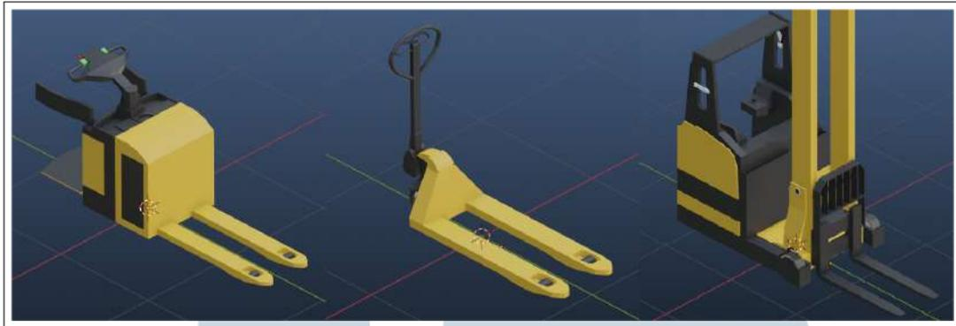
Gambar 3.9. Aset 3D Alat Angkut, dari kiri ke kanan: *Hand pallet*, *pallet mover*, dan *reachtruck*
