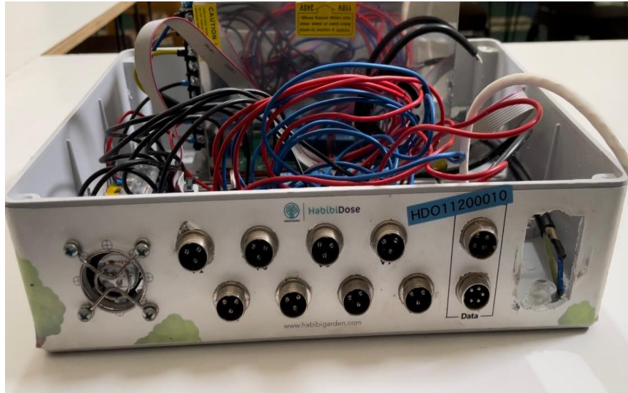
Gambar 3.9 Pengkabelan Pada PCB yang Memiliki Terminal Tidak Berurutan Desain ulang sistem Habibi Dose dilakukan menggunakan software eagle . Tahapan pertama yang dilakukan dalam mendesain ulang modul relay Habibi Dose adalah membuat desain schematic pada software eagle . Berikut ini merupakan bentuk desain schematic modul relay yang didesain pada software eagle .
