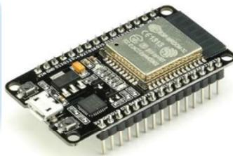
Gambar 3.3 Mikrokontroler ESP32
