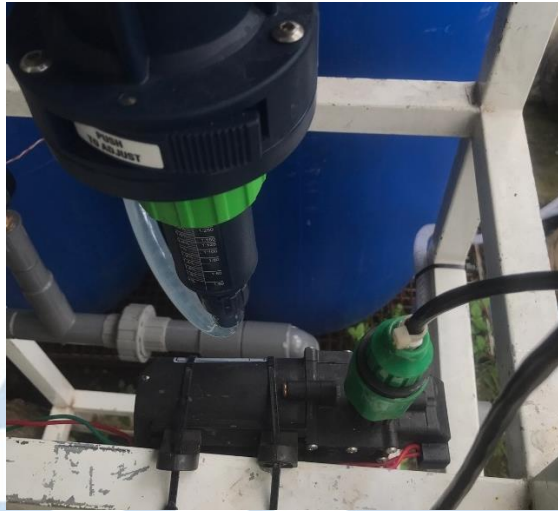
Gambar 3. 16 Posisi Pompa Air Pendingin
