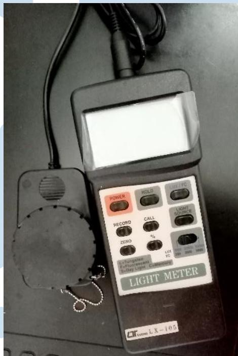
Gambar 2.11 Lux Meter Lutron LX-105
