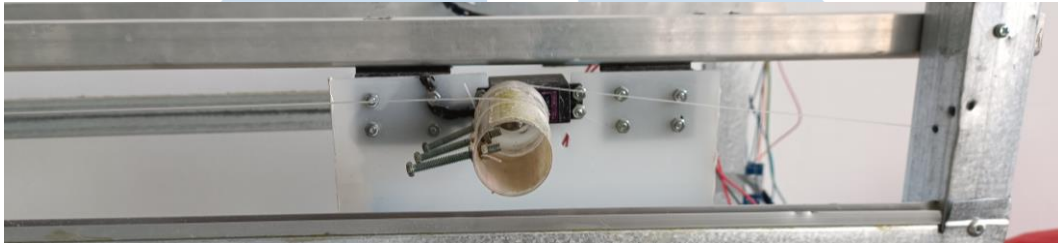
Gambar 3.10 Sistem Pergerakan Vertikal
