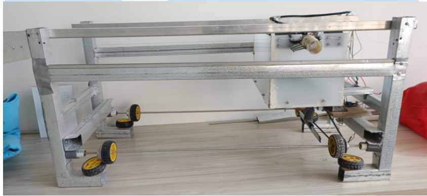
Gambar 3.7 Tampak Samping Prototipe Pembersih Panel Surya Otomatis
