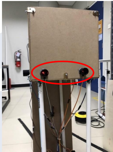
Gambar 3.9 – Kondisi KY-022 IR Receiver Mendeteksi Sinyal Inframerah dari KY-005 IR Transmitter
