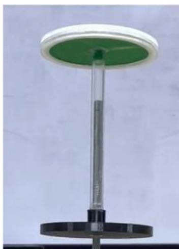
Gambar 4.13 : Pengujian kebocoran ballast tipe 2
