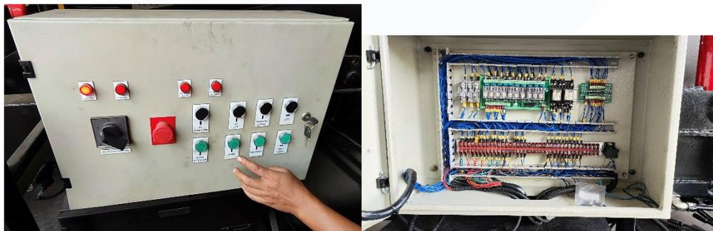
Gambar 3.6. Panel kontrol HCT (kiri) dan bagian pengkabelan panel control HCT (kanan)
