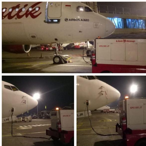
Gambar 3.27. penggunaan GPU AC di Pesawat Airbus A320 Batik Air
