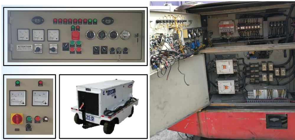
Gambar 3.10. Panel Kontrol GPU Lama (kiri) dan Pengkabelan GPU AC-DC Lama (kanan)
