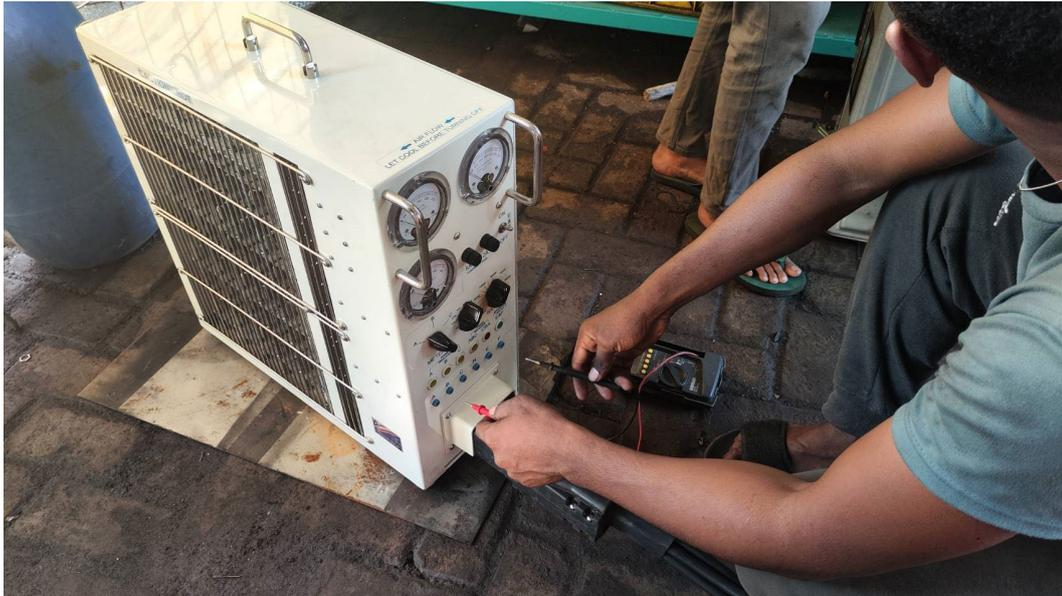
*Gambar 3.23. Pengujian GPU Output AC dengan Load Bank AC*
