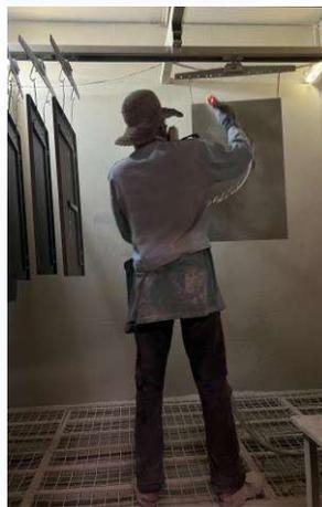
Gambar 3.20 Proses Pengecatan Rangka Panel
