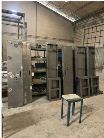
Gambar 3.16 Hasil Dempul Rangka Panel
