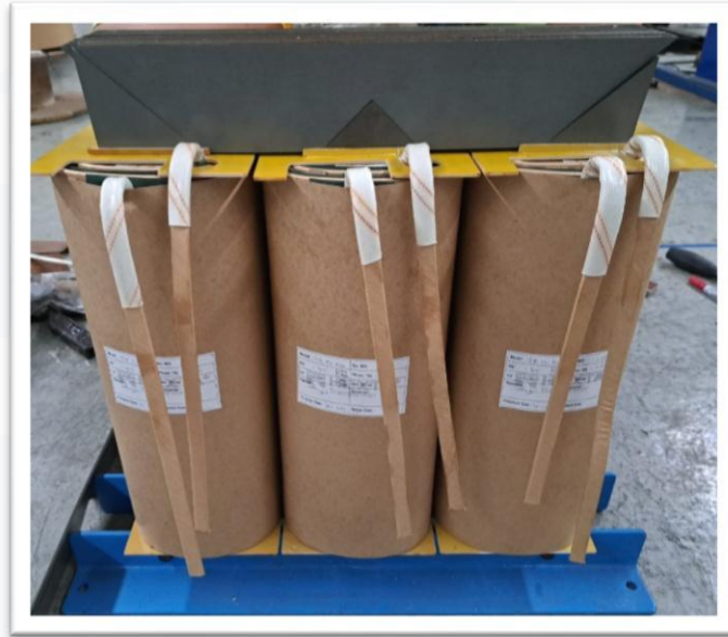
Gambar 2.6 Proses Pemasangan Coil ke Core
