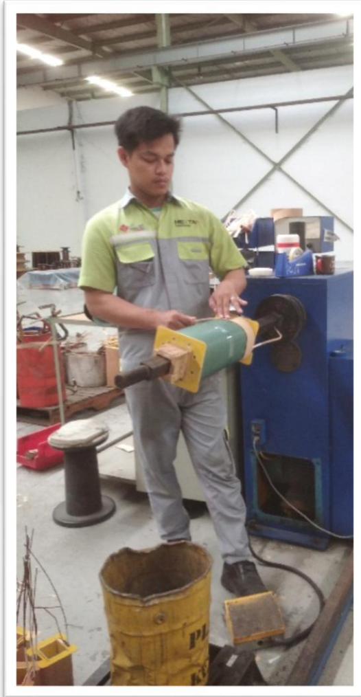
Gambar 2.6 Proses Menggulung Kawat
