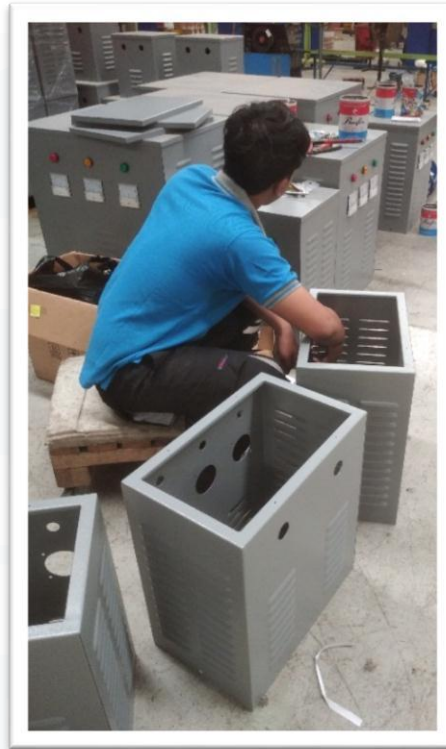
Gambar 2.6 Proses Pemasangan Box
