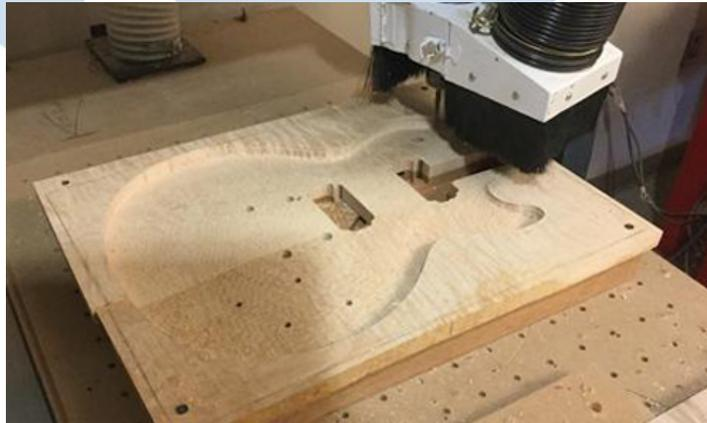
Gambar 2. Penggunaan mesin CNC dalam mencetak bodi gitar
