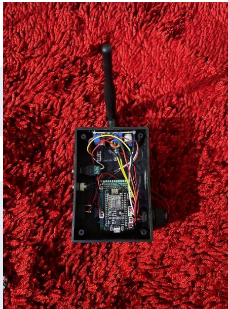
Gambar 3.25 Implementasi Rangkaian Transmitter
