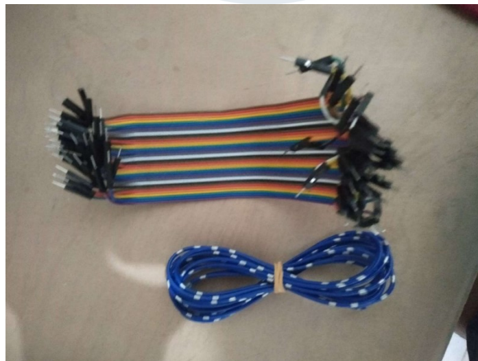
Gambar 3.9. Kabel Jumper dan Kabel Tembaga
