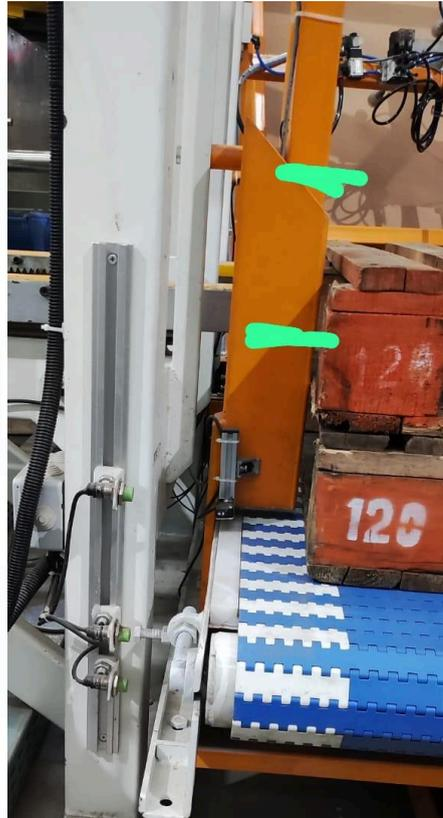
Gambar 3.47. Letak penempatan untuk penambahan sensor IR4PD dan IR5PD pada subsistem *pallet dispenser*.
