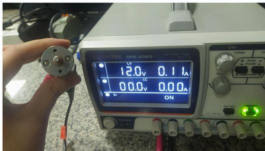
Gambar 3.20 Pengujian Motor DC dengan *Gearbox*
