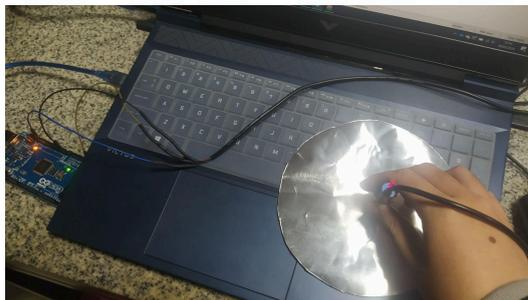
Gambar 3.3 Pengujian Sensor Induktif dengan Sampah Logam
