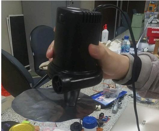
Gambar 3.22 Pengujian Motor Pompa untuk Menyedot Sampah Besi
