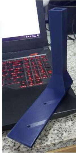
Gambar 3.22 Sambungan Penyangga Lengan ke Alas Robot
