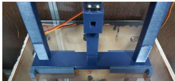
Gambar 3.24 Sambungan Lengan Robot ke Dinding Kanan dan Kiri Robot
