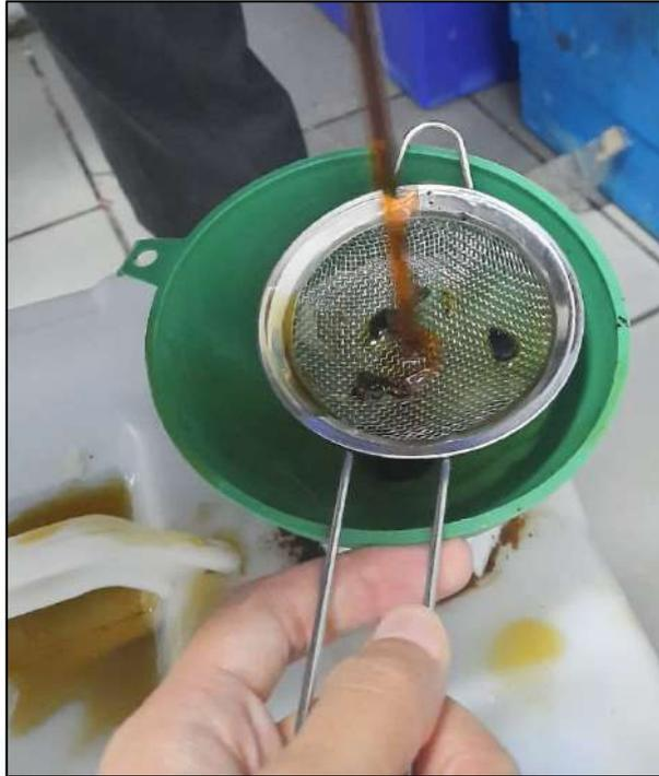
Gambar 3.11 Proses penyaringan minyak bekas
