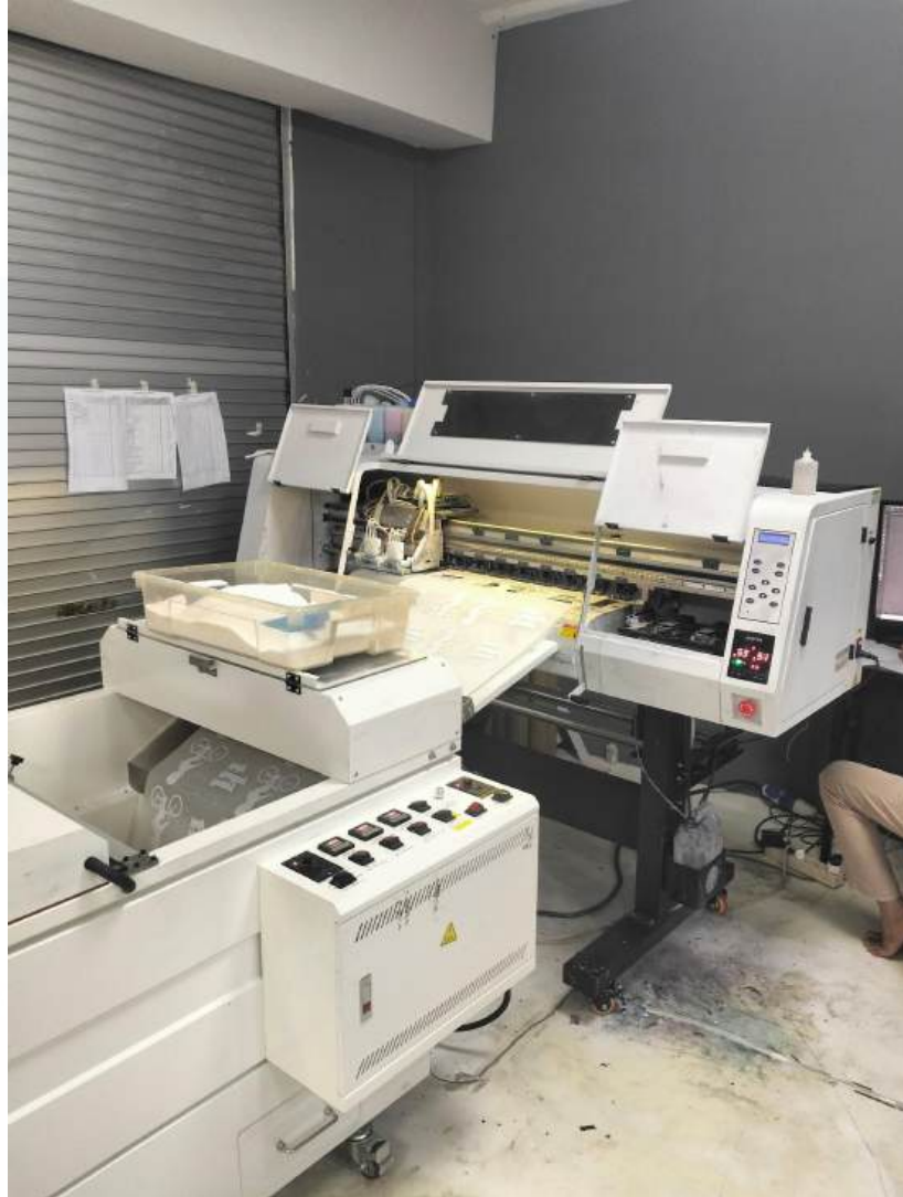
Gambar 3.35 Mesin dimana Kertas lembar sablon DTF di cetak dan akan di sablon ke baju.
