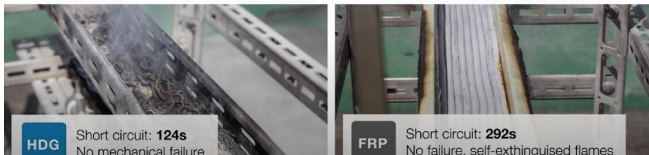
Gambar 1.1. 5 Uji Ketahanan Api oleh Øglænd System
