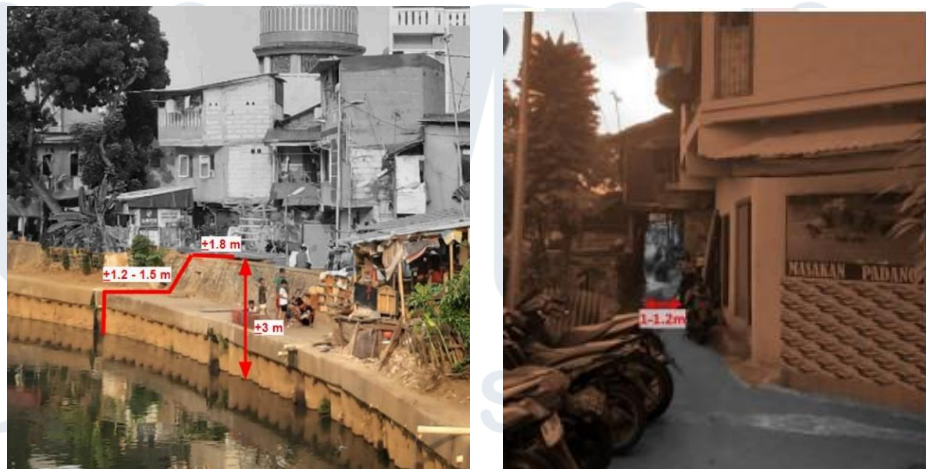
Gambar 3.6 Bantaran Sungai Ciliwung di Kalipasir sebagai Bantaran ' Raised ' (Sumber: Pengolahan dan Dokumentasi Pribadi, 2023)
