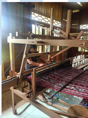
Gambar 3.6 Proses Tenun dengan Alat Tenun Bukan Mesin (ATBM)
