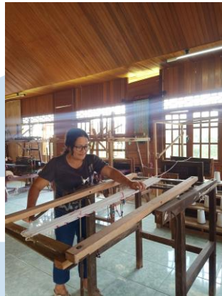
Gambar 3.1 Proses Plankan Benang
